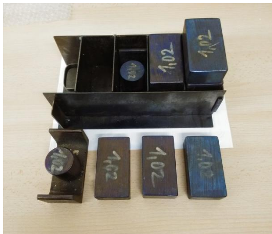
Obrázok 5: Forma a závažia pre výrobu experimentálnych vzoriek
