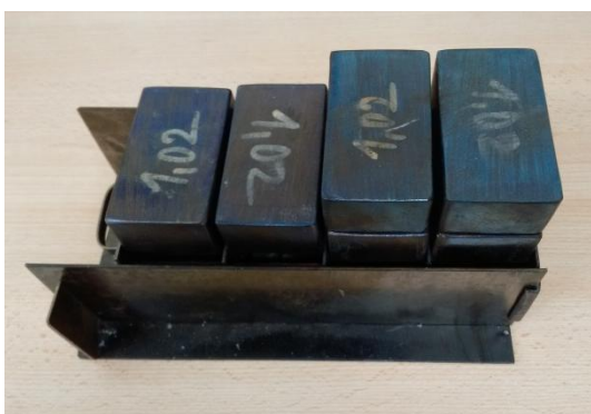
Obrázok 7: Zaťaženie vzoriek rôznym lisovacím tlakom
