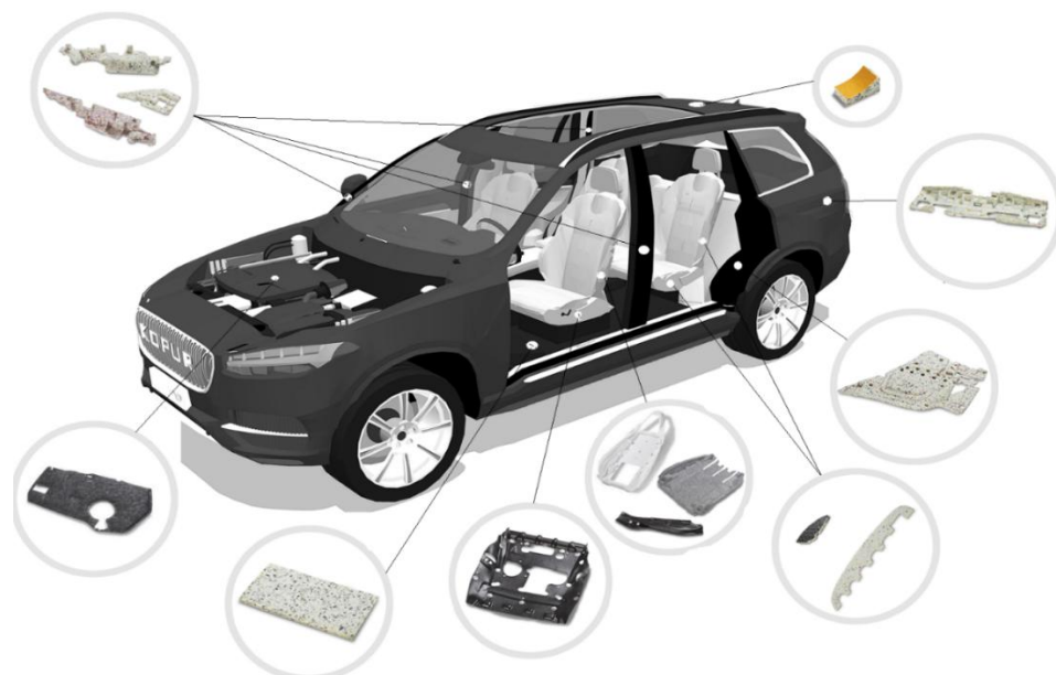
Obrázok 3: Akustická výplň vo vnútorných častiach vozidiel a výplň pre automobilové sedadlá
