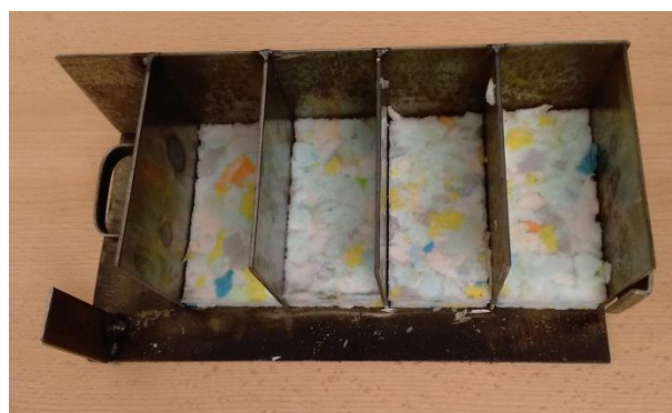
Obrázok 8: Vyberanie hotových vzoriek z formy
