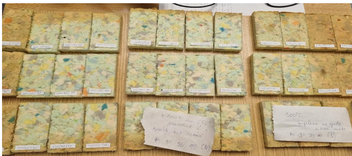
Obrázok 9: Skúšobné vzorky pri experimente suchého formovania pod tlakom
