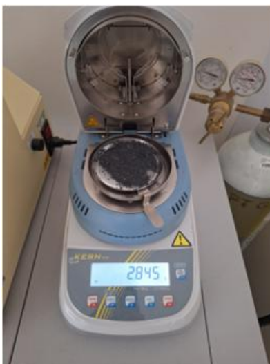
Obrázok 1: Vzorka pripravená na sušenie v sušiacей váhe KERN DLB
