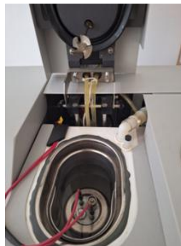
Obrázok 8: Natlakovaná kartuš so vzorkou pripravená na meranie výhrevnosti
