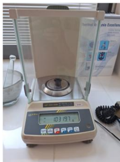
Obrázok 2: Následné váženie vzorky do nádoby kalorimetra na laboratórnej váhe KERN ABT 220 SDM
